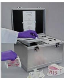
mit dem sich lebende Zellen schonend bei ihren optimalen Kulturbedingungen, zum Beispiel bei 37 Grad Celsius und einem Kohlendioxidgehalt (CO<sub>2</sub>) von 5 Prozent, bis zu 48 Stunden lang transportieren lassen. Der zum Patent angemeldete Mini-Inkubator ist leicht und nicht größer als eine Paketschachtel. Ein interner Lithium-Ferrum-Akku betreibt die elektronisch geregelte Heizung oder Kühlung und die CO<sub>2</sub>-Versorgung.
